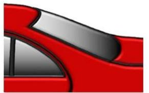
Lustrer la zone de raccord à l'aide d'un produit de lustrage grossier et essuyer tous les résidus. Poncer la zone de transition en direction de la zone de raccord avec par ex. un Disque de Finition 3M Trizact P3000 Fin ou un abrasif similaire d'autres fabricants. Nettoyer la zone préparée au Nettoyant Final Hydrodiluable 3911WB.
