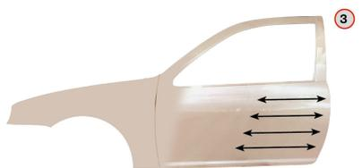
3 Après désolvatation de la surface jusqu'au matage, appliquer une couche fermée de Permahyd Blend-in Additive 1050 / 1051 pur (sans durcisseur) sur la zone de raccord.
